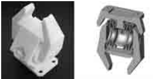
Ilustración 9: Ejemplo de integración de funciones en una sola pieza. Pinza para brazo robotizado. Fuente Fraunhofer IPA y EOS GmbH
