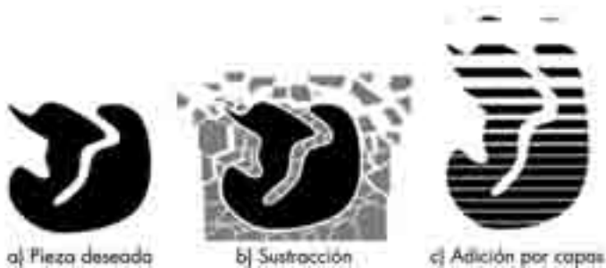
Ilustración 1: Concepto de fabricación sustractiva comparado con AM
