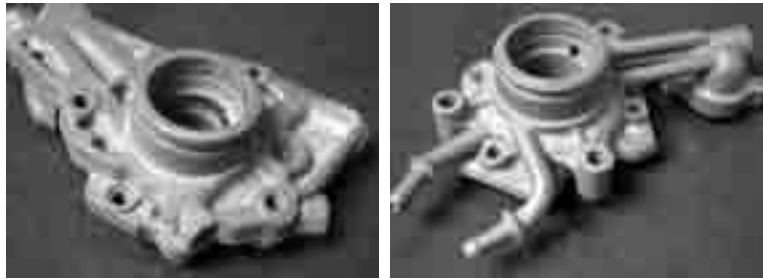
Ilustración 33: Ejemplo de pieza industrial. A la izquierda pieza original de fundición. A la derecha pieza rediseñada para AM. Cortesía de Loughborough University, copyright Econolist
