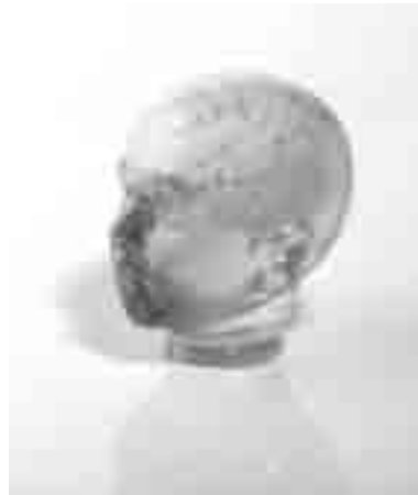
Ilustración 8: Ejemplo de pieza fabricada de una vez con una combinación de materiales con tecnología Objet
