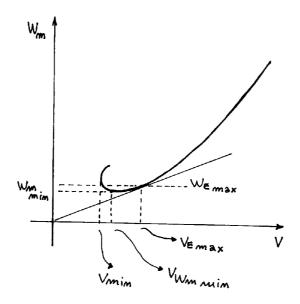
Wm/V = D condición de máxima ef. aerodinámica.
