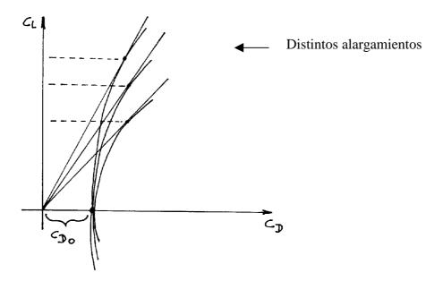
Se puede determinar un punto de la polar para una determinada velocidad y también para su carga alar:
