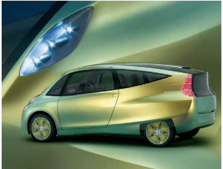
El Mercedes "Bionic Car", cuya silueta se asemeja a una gota de agua, tiene un Cx de solo 0,19.
