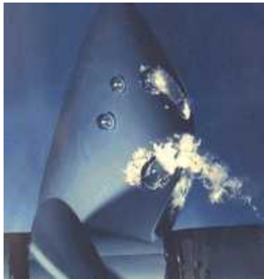
Figura 21: cavitación sobre álabe
