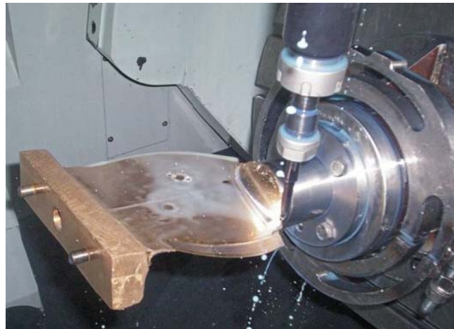
FIGURA 6 MECANIZADO DE UN ÁLABE DEL ROTOR KAPLAN
