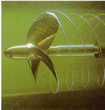
Figura 6.4.- Cavitación en una hélice marina (imagen global y detalle).
