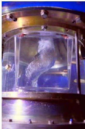
Figura 6.27.- Cavitación de antorcha en la salida de una turbina.
