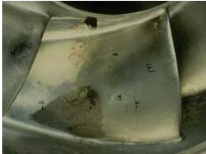
Figura 6.11.- Daño en un álabo debido a la cavitación de nube.
