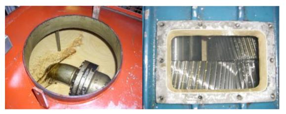
Espuma en un depósito de una turbina de vapor
