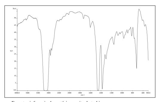
Espectro infrarrojo de un típico aceite de turbinas
