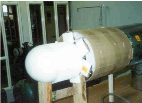
Foto No. 2 Spinner posterior para la turbina Wells
