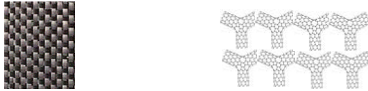
Figura 9. Tipología de parrillas de nanotubos (izquierda) y detalle de estructura bidimensional de nanotubos mediante la introducción de pares de efectos de tipo pentágono-hexágono en su estructura convencional.
