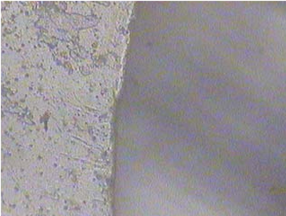
Figura 5-6: probeta ensayada a tracción de fibra de vidrio, división en la zona de rotura, resina epóxica (lado izquierdo) y fibra de vidrio (lado derecho). (100X)
