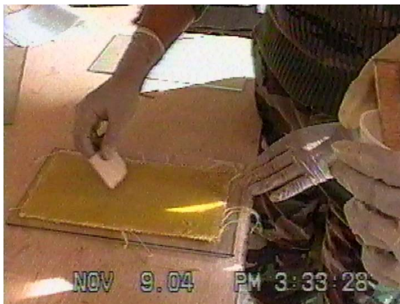
Figura 5-29: Colocación de la resina sobre la fibra.
