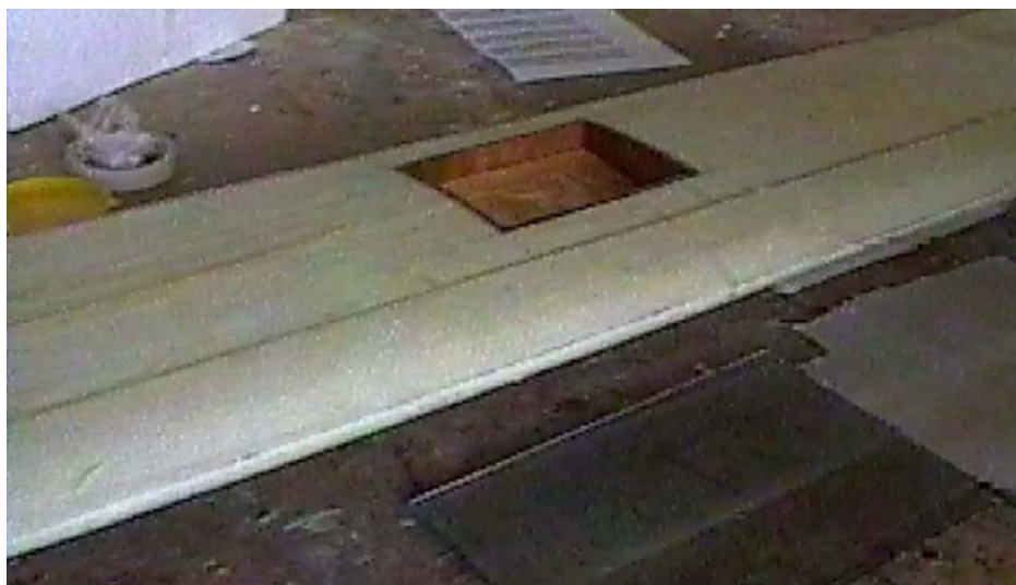
Figura 5-33: Estabilizador horizontal conformado por el método de “tendido manual”
