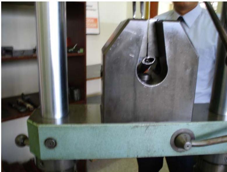
Figura 5-46: Colocación de la probeta en la máquina de ensayos universales
