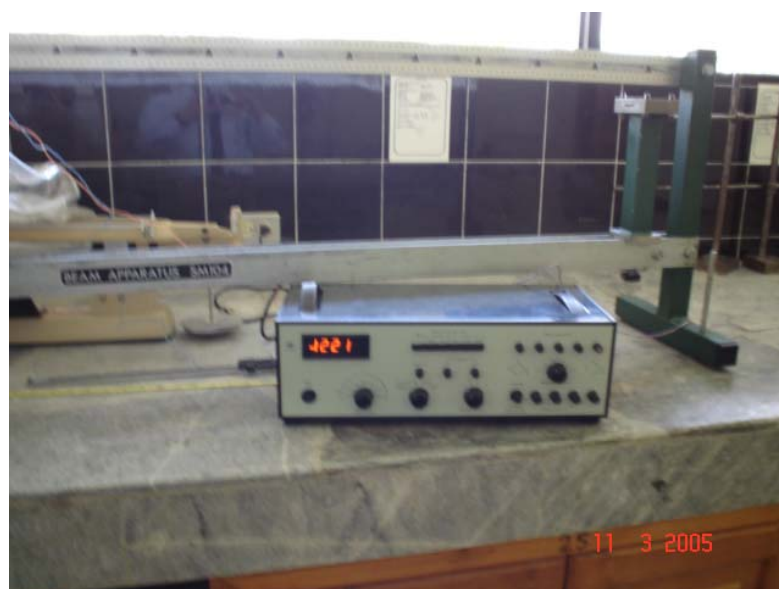
Figura 5-50: Medidor de deformación unitaria Brüel & Kjær
