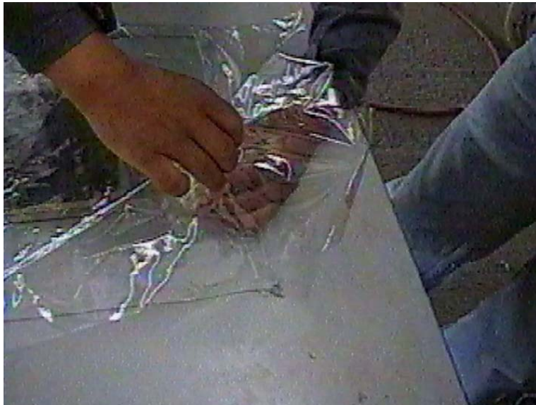
Figura 5-37: Sellado hermético para generar el vacío
