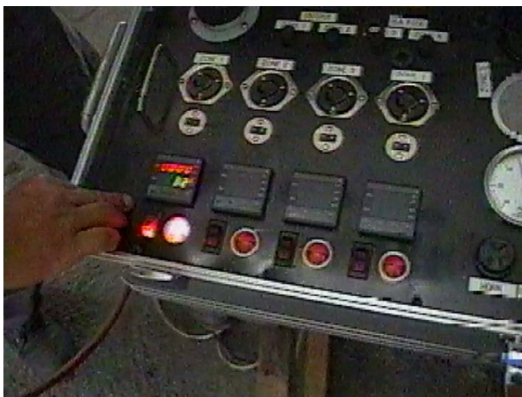
Figura 5-41: La máquina generadora de vacío puede conectar 4 mantas térmicas
