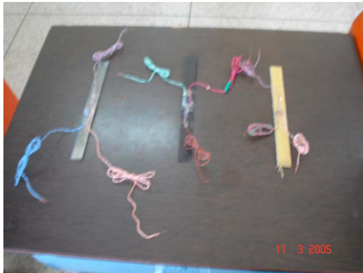
Figura 5-49: Probetas con sus respectivas rosetas de deformación.
