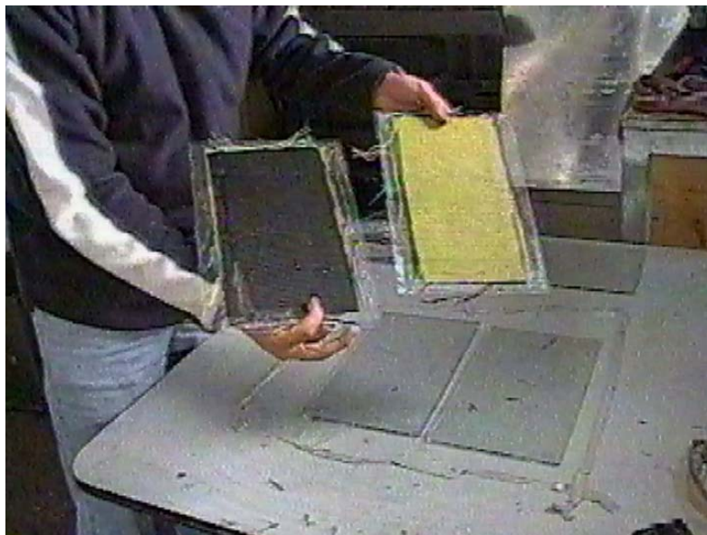
Figura 5-42: Probetas elaboradas con el método de “empaquetado al vacío”
