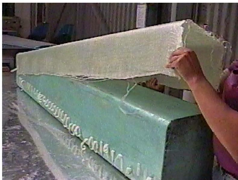
Figura 5-43:Elemento conformado por el método de “empaquetado al vacío”
