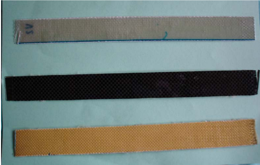
Figura 5-32: Probetas cortadas y listas para efectuar los ensayos
