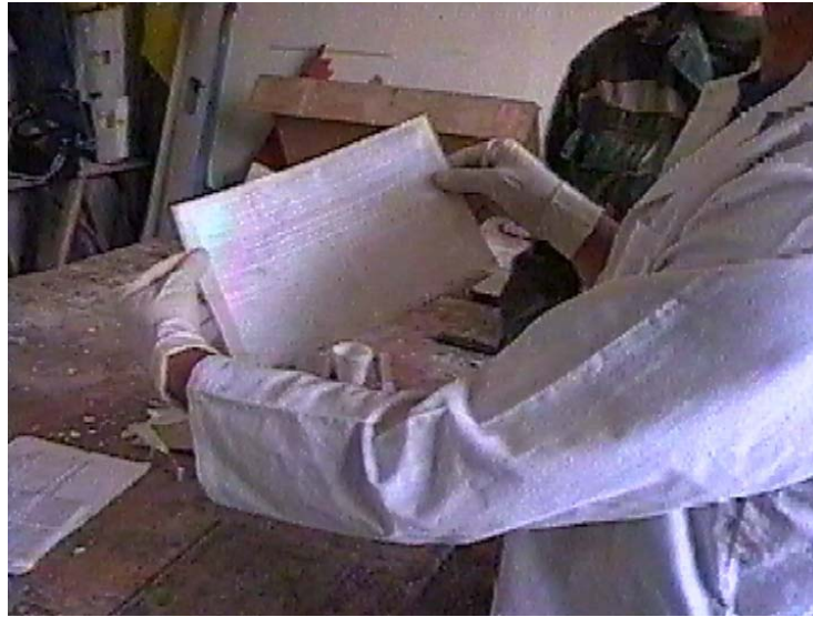
Figura 5-27: Fibra de vidrio lista para ser preparada con la matriz epóxica.
