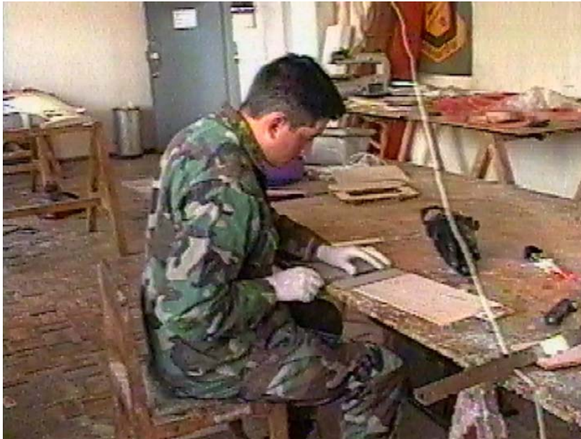
Figura 5-23: Medición previa al corte de las probetas
