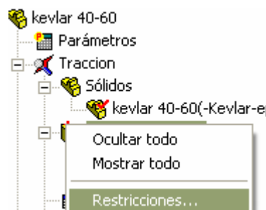
Figura 6-43: Selección de cargas / restricciones para la probeta
