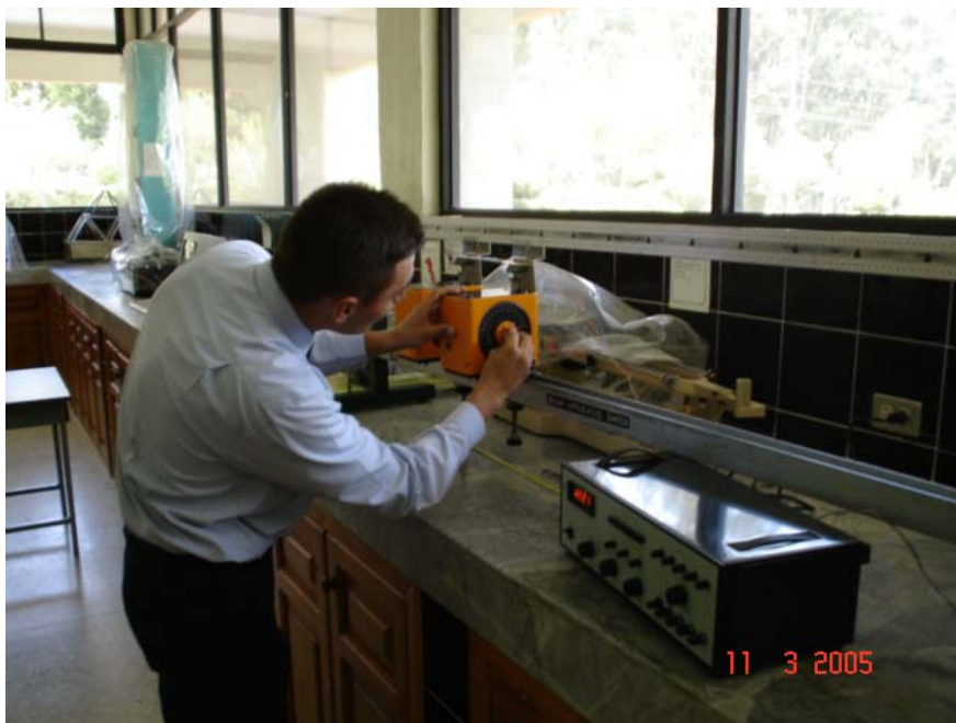
Figura 5-51: Ejecución del ensayo de flexión estática
