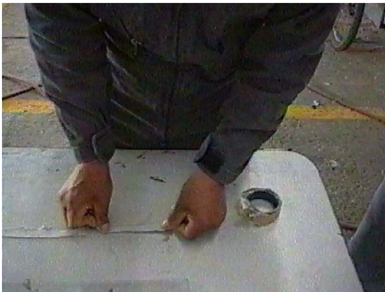
Figura 5-34: En la mesa de trabajo se coloca la cinta adhesiva
