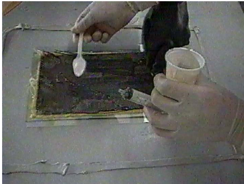
Figura 5-35: Esparcimiento de la resina sobre la fibra
