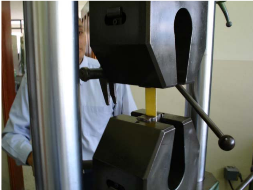
Figura 5-47: Inicio del ensayo, estirado hasta la rotura
