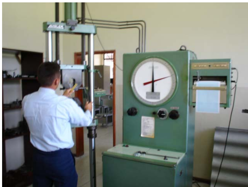
Figura 5-48: Obtención del diagrama Esfuerzo-Deformación durante el ensayo
