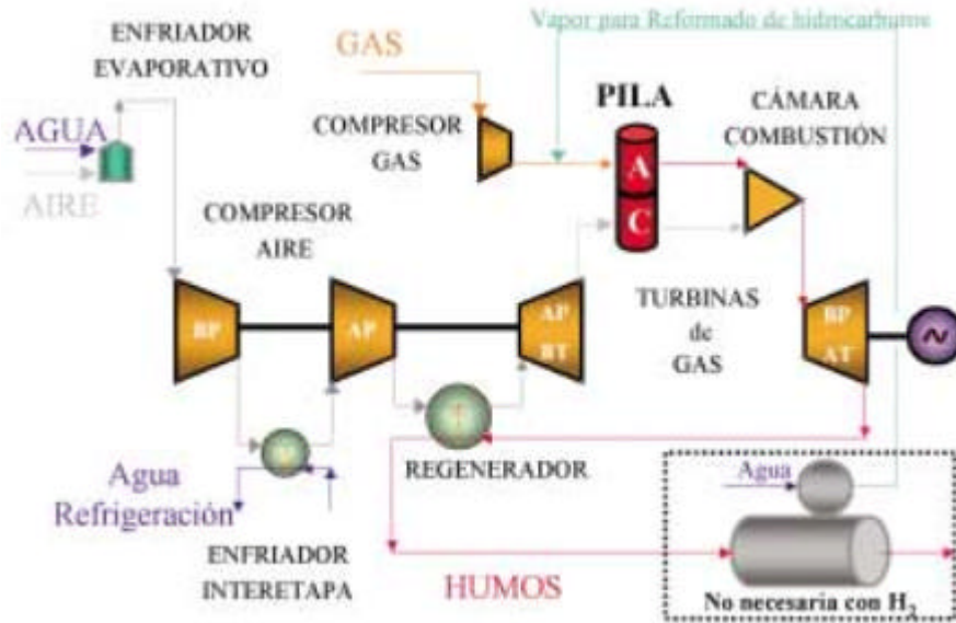
Figura 6. Ciclo combinado pila de combustible - Ciclo de Brayton [5]
