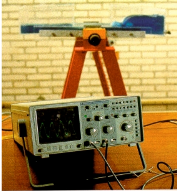
Figura 5.- Dispositivo del ensayador de tanques estabilizadores
