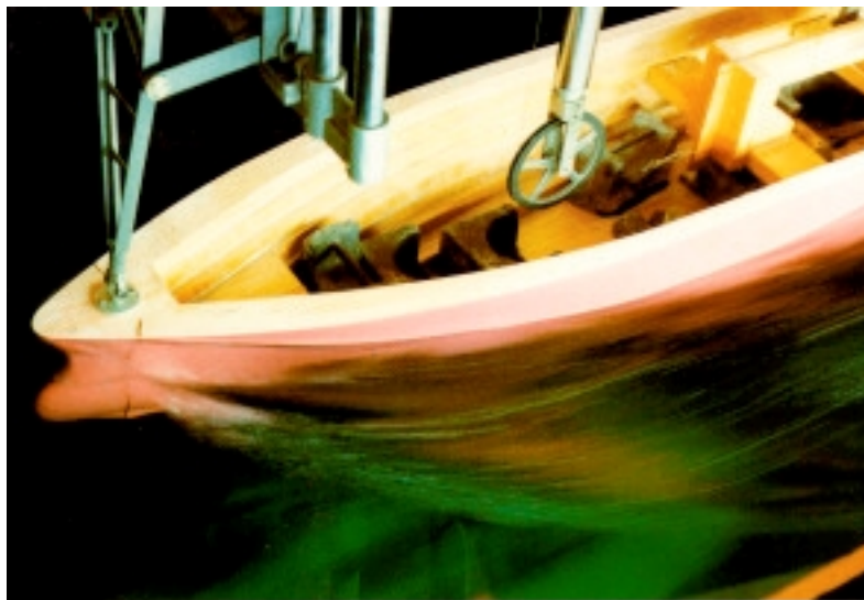
Figura 4.- Modelo en un ensayo de remolque
