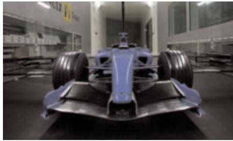
Figura 2. Sección de ensayos del túnel de viento del equipo Renault FI. ©Renault FI Team
