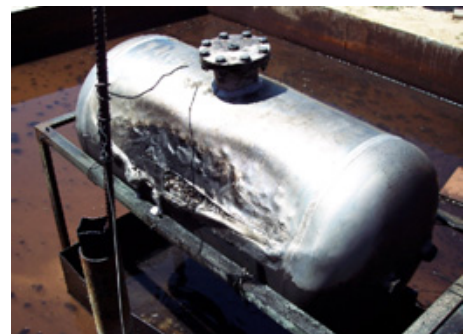
Fig. 7. Estado del depósito que contenía la malla metálica en su interior después de haberlo sometido a llamas directas.
