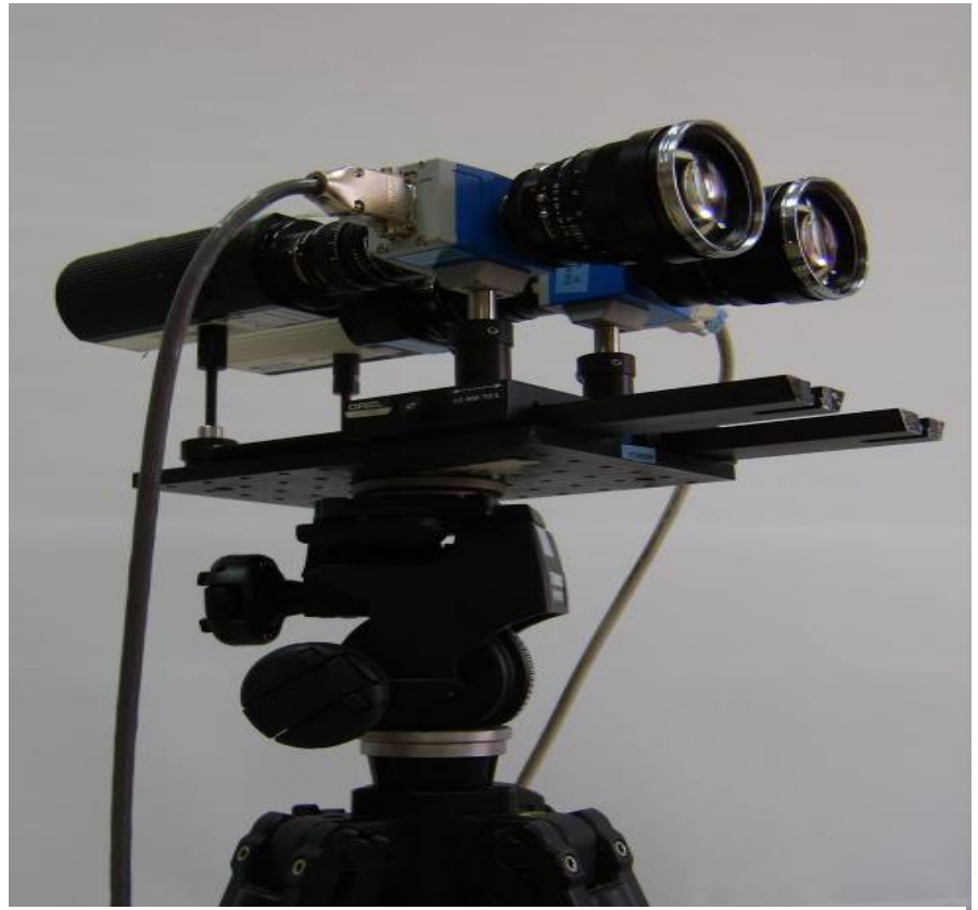
Fig. 1. Configuración del sistema imagen hiperespectral en visible.
