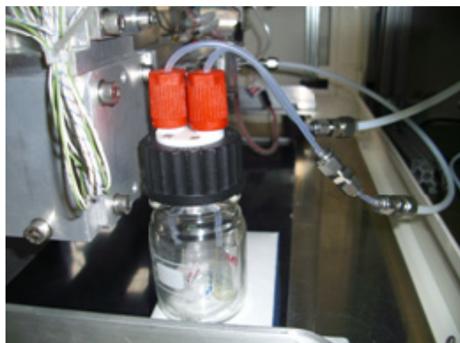
Fig. 2. Sistema de introducción de muestra para análisis de espacio de cabeza mediante UV.
