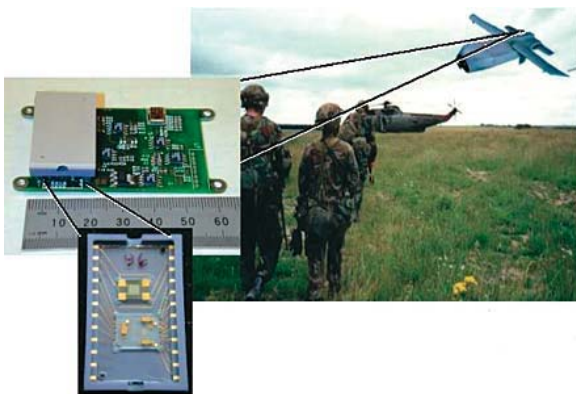
-SnifferSTAR: nanosensor químico integrado en un UAV. Fuente: Sandia National Labs, Albuquerque NM y Kockhee Martin Corp-
