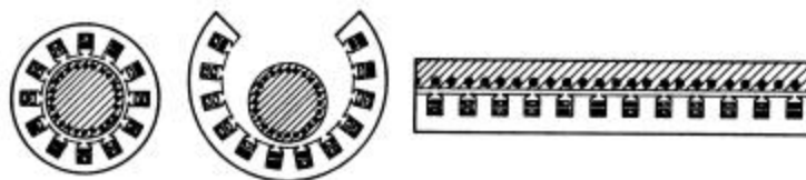
Fig. 1: Transformación topológica de un motor de inducción rotativo en un motor lineal plano.
