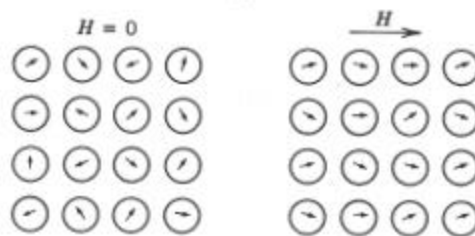
Fig. 5. Esquema de los dipolos magnéticos en un material paramagnético
