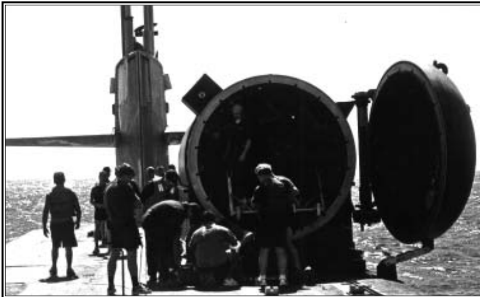
Utilizado tanto por la Armada Norteamericana (foto) como la Británica, el Refugio Seco en Cubierta de General Dynamic Electric Boat es un agregado útil para las misiones de las Fuerzas Especiales navales. Además de otras características, puede albergar una cámara de descompresión.
