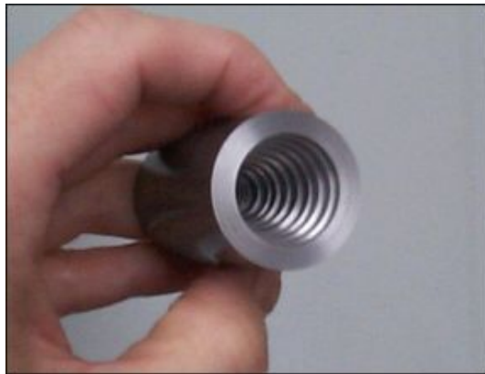
Figura 10. Perfil escalonado resultante de los taladros sucesivos.
