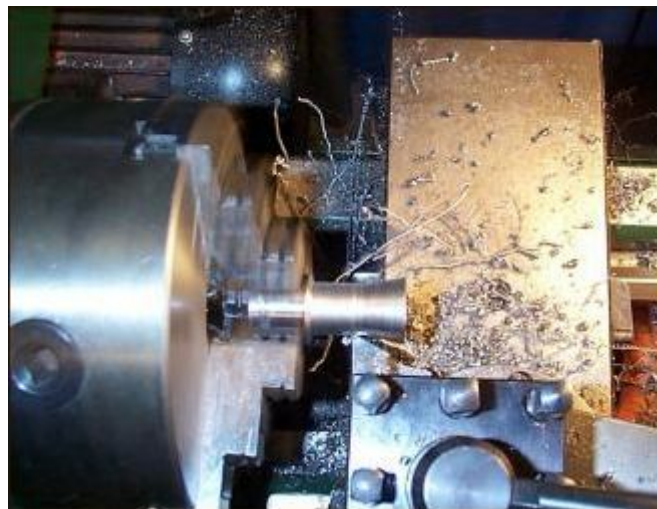
Figura 12. Utilización del carro con avance automático para cortar el metal rápido y fácilmente.
