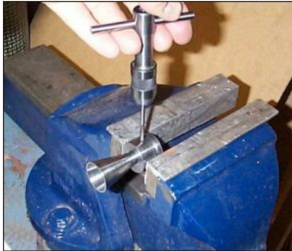
Figura 13. Roscado de los agujeros de fijación.
