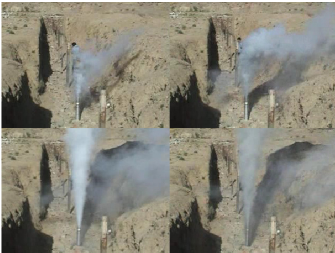
Foto 3. Muestra la combustión del motor AE-1A, en una secuencia de fotografías. El funcionamiento exitoso del motor se dio por las modificaciones en el ultimo grano propelente y en el diámetro de la tobera ya mostrados en las características del motor.
