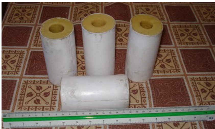
Foto 1. Muestra los cuatro granos de propelente ya moldeados, los cuatro con un núcleo circular, tres con 1cm de núcleo y uno con 1.5cm de núcleo, además los granos de propelente tienen inhibidores.
