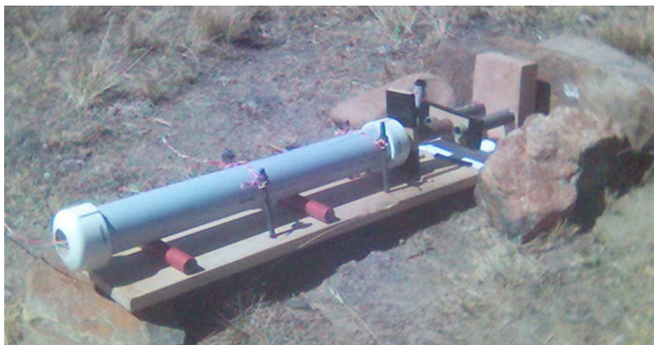
Foto 2. Muestra el motor de cohete que contiene en su interior los cuatro granos de propelente y la tobera
