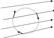
Si la carga es lanzada dentro del campo con un cierto ángulo la velocidad tendrá una componente perpendicular al campo que sufrirá la fuerza magnética que le hará girar y otra paralela al campo que no sentirá fuerza ninguna y originará un movimiento de avance rectilíneo y uniforme, el resultado será un movimiento helicoidal.
