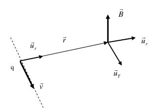
La dirección y sentido del campo se obtiene multiplicando vectorialmente los vectores unitarios en la dirección del movimiento y en la línea que une la carga con el punto en que queremos medir el campo  $\vec{u}_T x \vec{u}_T$
