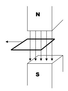
Si vamos sacando la espira el flujo disminuye, como se trata de un flujo entrante, la corriente inducida en la espira irá en el sentido de las agujas del reloj para generar otro flujo entrante que compense la disminución.
