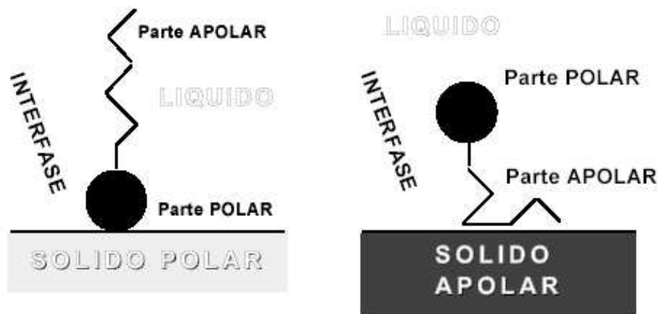
Figura 4: Ferrofluido en interacción con sólidos polares y apolares
