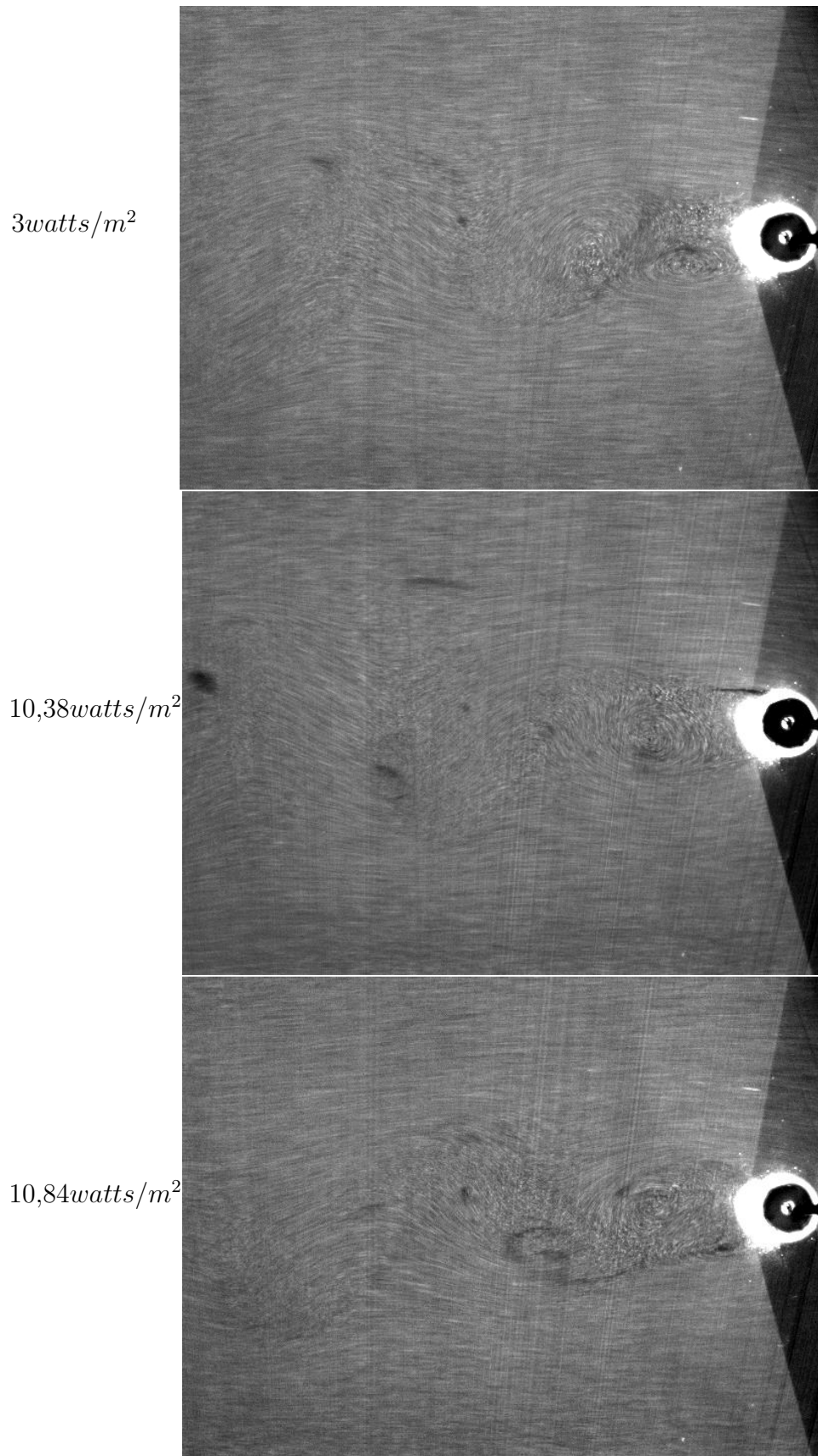
Figura 5.17: Visualización del flujo bajo actuación EHD. Re = 125
