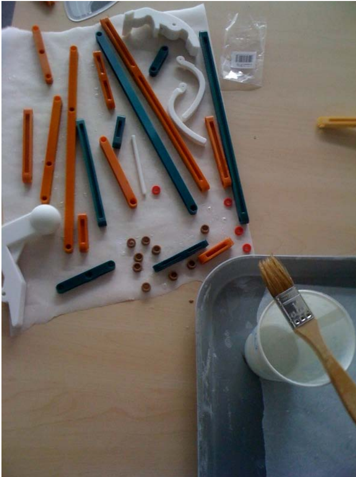
Figura 43. Aplicación de epoxi con un pincel.
