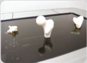
Prototipo del dispositivo médico e implante de Orchid impreso con la impresora 3D de escritorio Objet30
