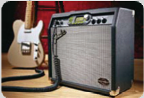
Prototipo del amplificador de guitarra de Fender impreso con la impresora 3D Objet
