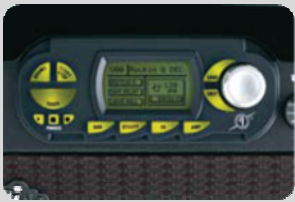
Prototipo del amplificador de guitarra de Fender impreso con la impresora 3D Objet
